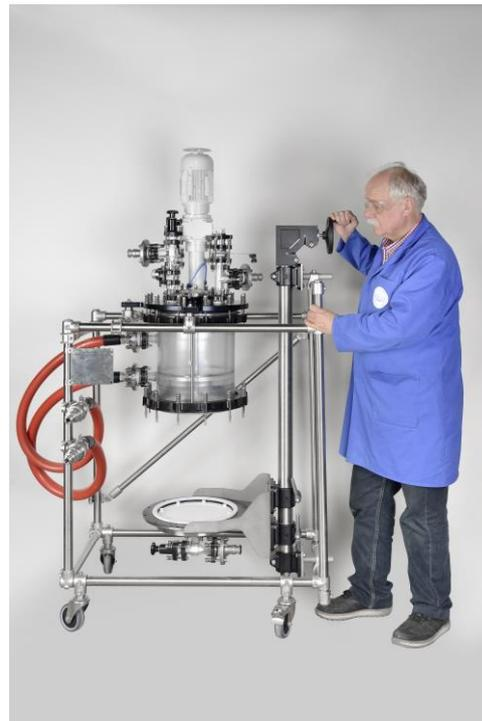
**Schritt 6:** Absenkung Boden mit Filterplatte ohne Glaszylinder
