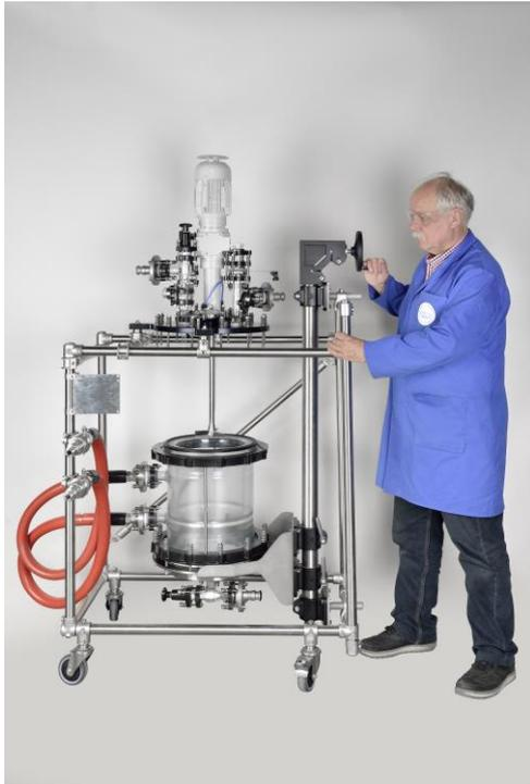
**Schritt 5:** Absenkung Boden mit Filterplatte und Glaszylinder
